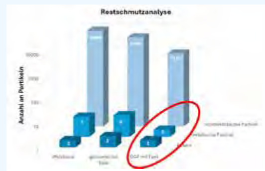
Einfluss der Oberfläche auf die Restverschmutzung bei einer Prüfung in Anlehnung an die VDA19.1 / ISO16232.
