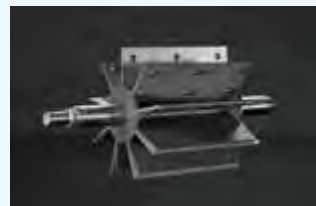
Semi-Endschild mit austauschbare und einstellbare Blätter
