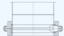
WCWC (WeldedClamp-WeldedClamp) Valve-Halbkörper mit angeschweißtem Rohr
