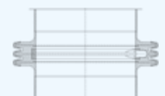
RCRC (ReleaseClamp-ReleaseClamp) Zwischen zwei MF -Verbindungen an beiden RC -Halbkörper-Seiten
