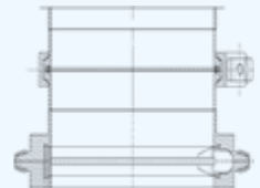
WCWC (WeldedClamp-WeldedClamp) Valve-Halbkörper mit angeschweißtem Rohr mit TriClamp Anschluss
