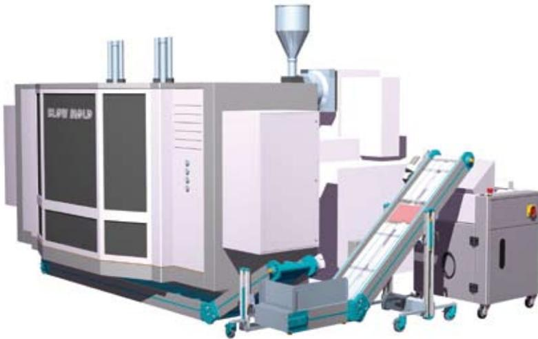
Die Abbildung zeigt den Metal Detector mit Plattenform, der sich innerhalb des Förderbands Modell N-CPR befindet, um während der Beförderung des Materials von der Spritzgussmaschine zum Recycling-Granulator metallische Verunreinigungen zu erfassen.
