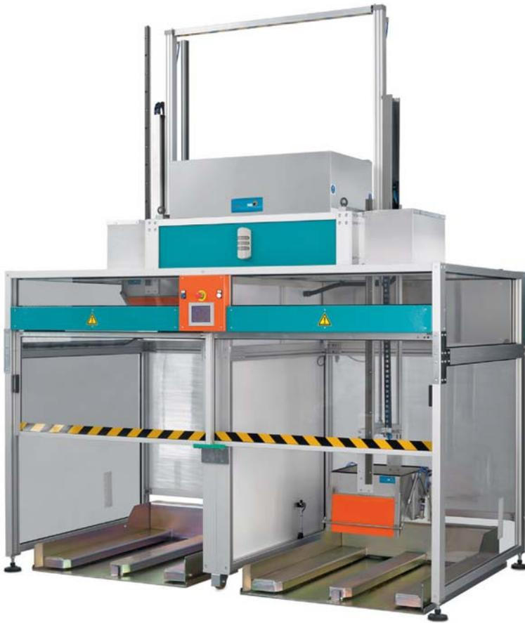
Seit 1991 hat MB Conveyors ein sehr wirksames System entwickelt, um Schäden zu vermeiden, die an den PET-Vorformlingen während der Abfüllung in Sammelbehälter verursacht werden. Das Betriebsprinzip des Soft Drops: Der Spritzzyklus wird auf der Spritzgießmaschine gesammelt und über ein CPT Förderband zum PA Förderband/Verteilerband weitergeleitet, das zum programmierten Abfüllen der Trichter/Absteiger installiert ist.
