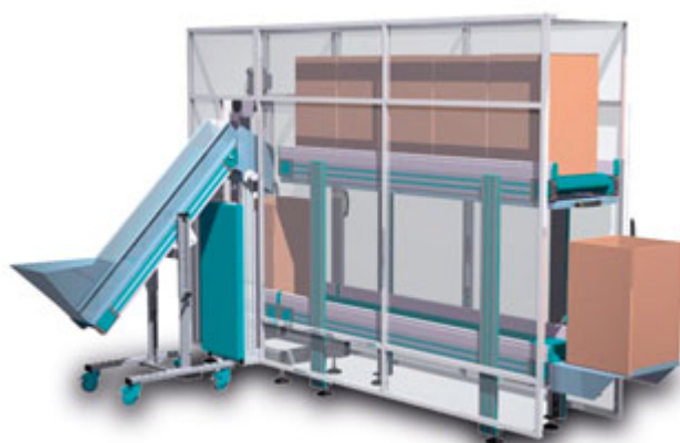
Storage Systeme Anlagen mit z. B. gravimetrischer Verwiegung, Produktweichen, Rüttelplatten, etc. ...
