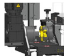
Schnellkupplungs-System Schnelles Entkoppeln von Schneidkammer und Antrieb
