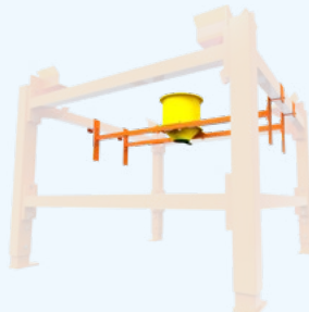
Dosing Container mit Schieber
